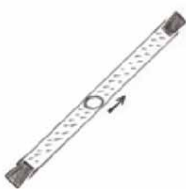
شکل ۶: حرکت یکنواخت حباب‌های آب به طرف بالا (آزمایش معلم)
